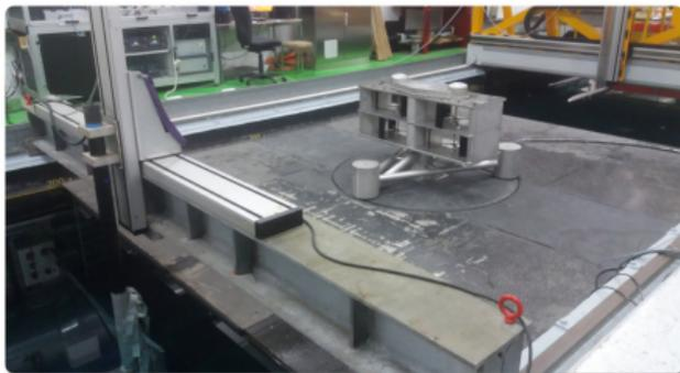
Fond relevable en position haute supportant la maquette HydroQuest
